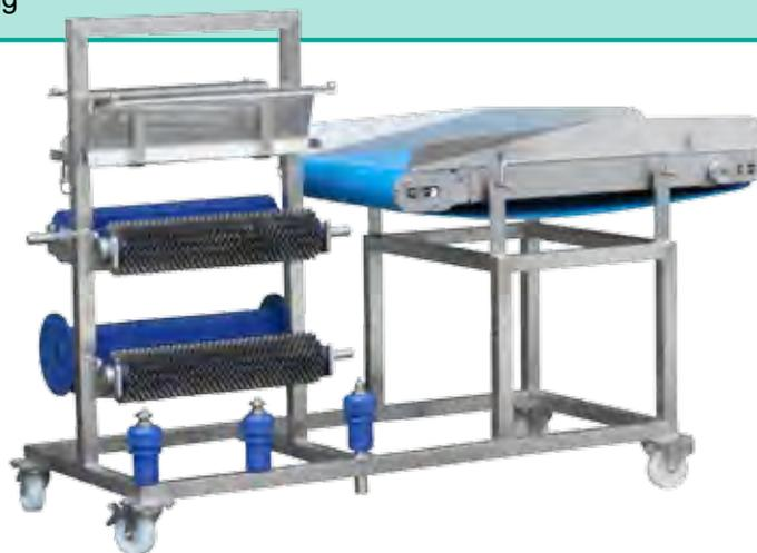
Durch die Höhen- und Druckregulierung der Messerwalzen kann das Produkt von schonend bis sehr intensiv bearbeitet werden. Natürlich sind eine oder beide Messerwalzen durch Quetschwalzen austauschbar. Zur leichten Reinigung sind Messerwalzen, Abstreifer und Transportband binnen Sekunden zu entnehmen.
